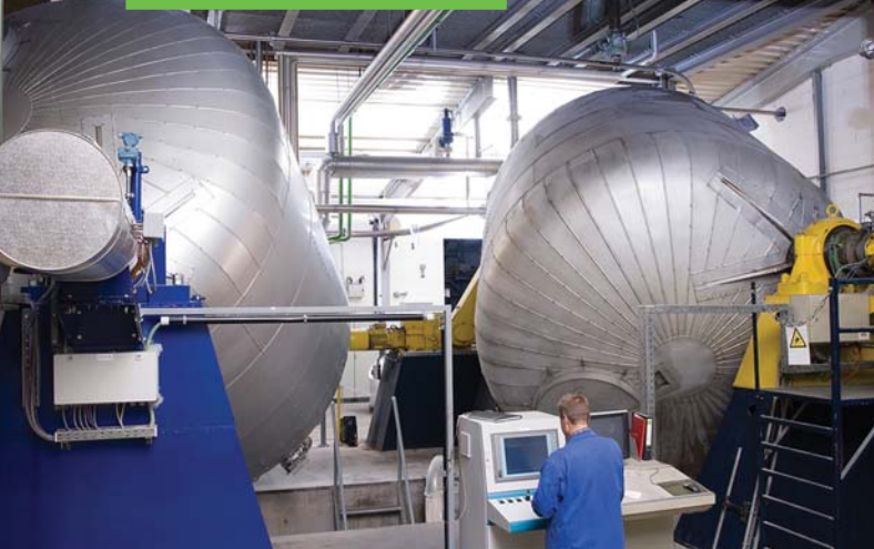
OHL-Reaktor in einer Recyclinganlage mit einer Kapazität von über 20.000 Tonnen pro Jahr (links). Durch Steuern der Parameter Temperatur, Vakuum und Zeit lassen sich Granulate – Rezyklate und Neuware – im OHL Taumelreaktor individuell, je nach technischen Vorgaben und Anforderungen, und mit oder ohne definierte Zugabe von Hilfsstoffen auf die geforderte Qualität bringen.
